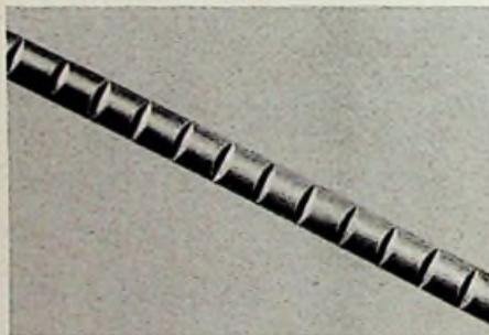
Bild 1a. Gitterholm mit eingeschnittenen Kerben (vergrößert)
